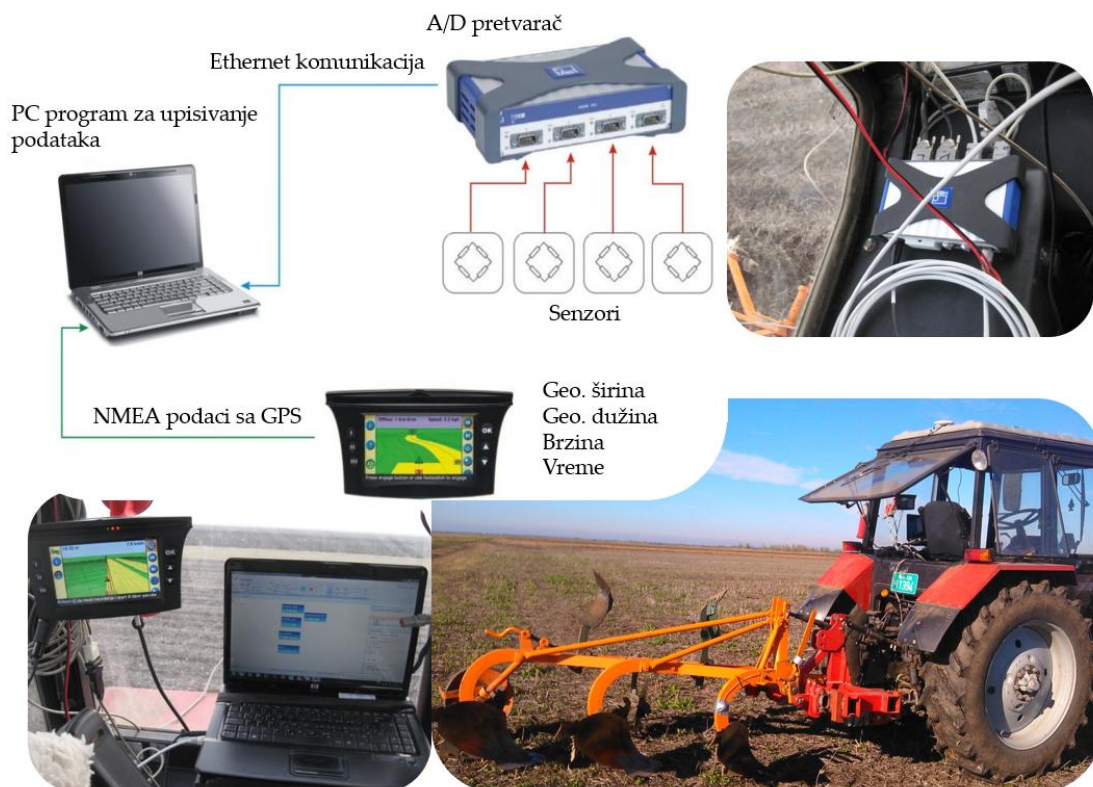
Slika 1.25. Sistem za merenje otpora obrade zemljišta u realnom vremenu i prostoru ( Kostić et al., 2014; Kostić et al., 2016 )
